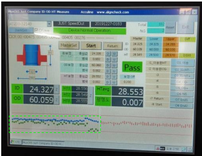
CNC 간이자동화라인 하부 Drop → 이동 → 상하구동 측정 → 배출 (불량선별)
