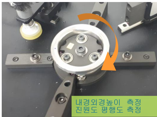
외경+진원도 Runout 3Ch
